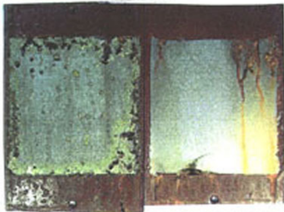
Abb.7a: Bleche - Belastungsdauer 72 h IH 42 light links K rechts
